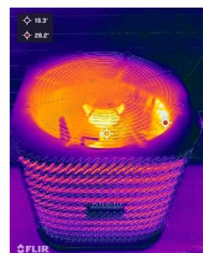
Fehlerbehebung für eine Kondensatoreinheit mit einer verstopften Spule, für Leckagen von Kältemitteln oder für Probleme mit dem Motor
